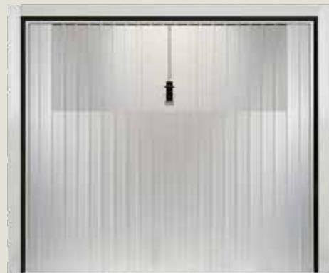
Porta basculante Sikura HF, con fascia incorporata nell'anta mobile in lamiera forata (fori Ø 6 mm pari a un 1/3 della porta (basculante L 260 x H 220 cm). Verniciata Primer per interni Ral 9010.
