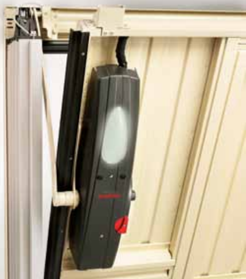
Il monobraccio di sostegno e di movimentazione della parte mobile, brevetto Ballan, è stato opportunamente sagomato. L'automazione è integrata con la porta e si avvale di due motoriduttori irreversibili a bassa tensione. La luce di cortesia è inserita nella protezione.
