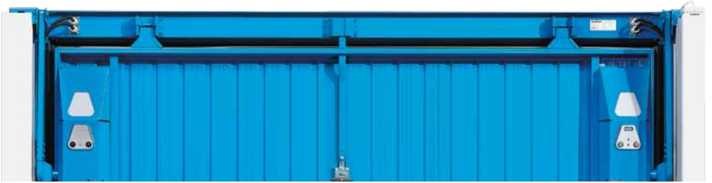
Vista interna serratura standard con 1 punto di chiusura centrale per struttura Sikura HF, Sikura HF City.
